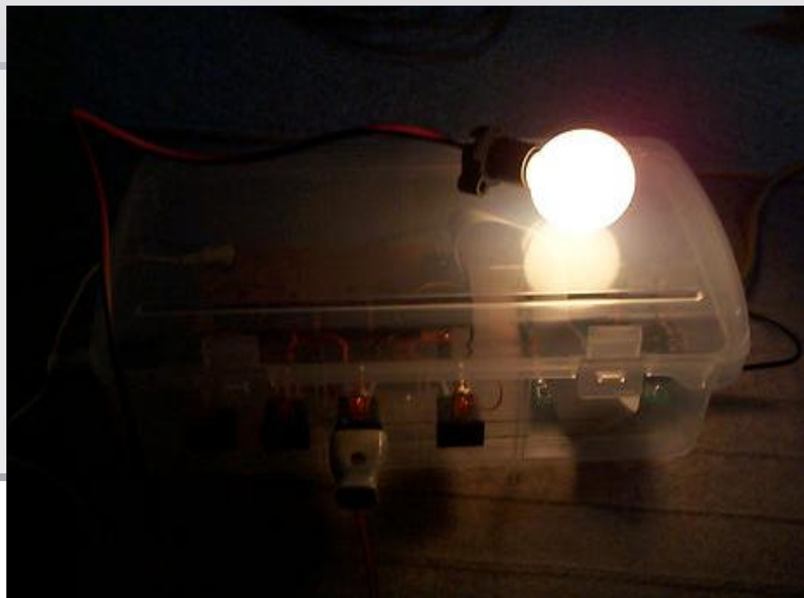
図7. Webブラウザ上からRB4~RB7をHIGHに設定して点灯確認をした。
