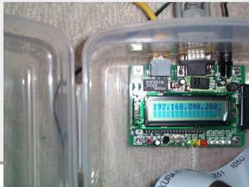
図5. LCDモジュールのIPアドレス表示
